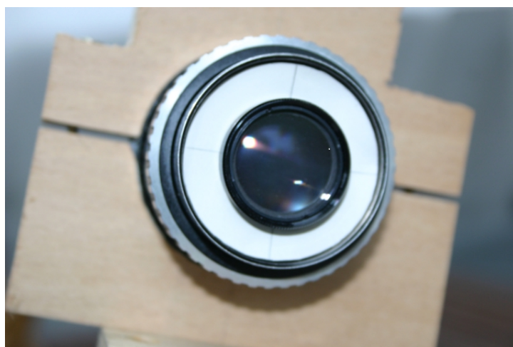
Abb. 1 Der StarAnalyzer 100 im Filtergewinde des Zeiss Sonnar 135 mm Tele
